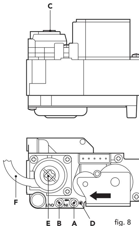
**Una volta effettuato il controllo della pressione o la regolazione della stessa è obbligatorio sigillare con vernice o apposito sigillo la vite di regolazione.**
