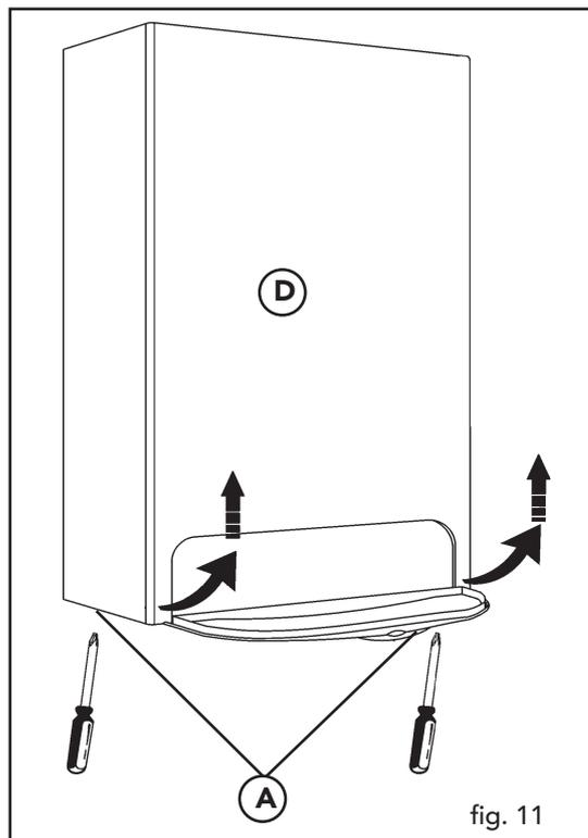
**Pulizia della caldaia e del bruciatore**
